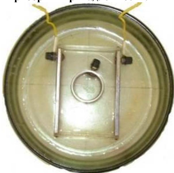
стеклянная ванна с электродами и координатной сеткой
